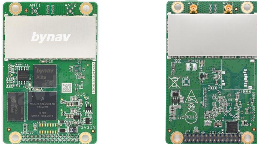
图 1 高精度 GNSS 板卡 C1 外观图
